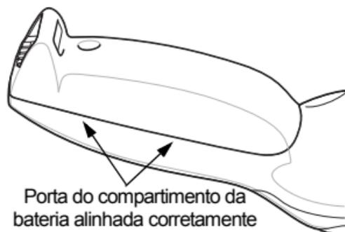
11. Use uma chave Torx T8 para fixar a tampa da bateria com o parafuso Torx. Aperte os parafusos até o torque de  $3,3 \pm 0,2$  Kgf/cm.
